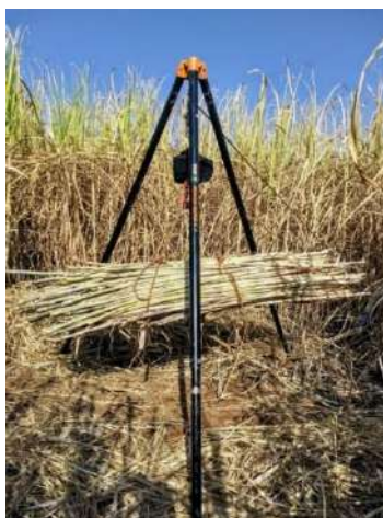
Figura 2. Pesagem da cana-de-açúcar colhida com o auxílio de balança acoplada ao tripé
